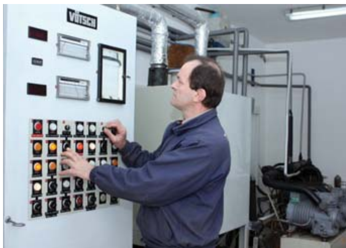
Генерално ремонтована комора за temperирање наоружања
