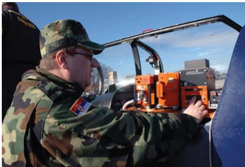
Предполетни преглед испитно-мерне опреме на авиону „лоста“
